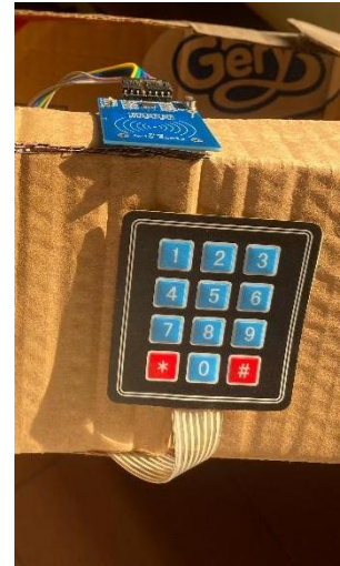
Gambar 7. Pemasangan Keypad 3x4 pada Sistem Keamanan Pintu
