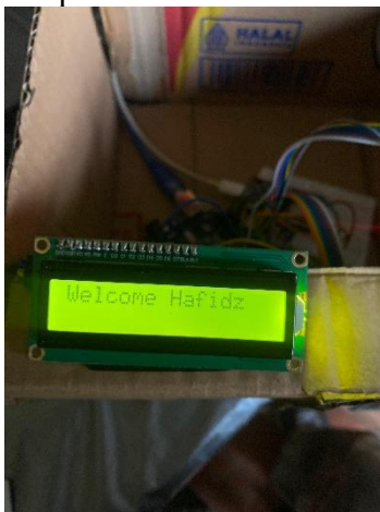
Gambar 9. Pemasangan LCD dalam Sistem
