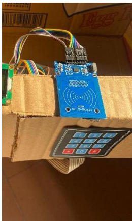
Gambar 6. Pemasangan Modul RFID pada Sistem
