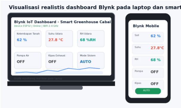
Gambar 5. Visualisasi dashboard Blynk pada laptop dan smartphone untuk monitoring smart greenhouse.
