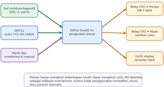
Gambar 2. Arsitektur sistem smart greenhouse cabai berbasis IoT tanpa humidifier, servo, dan paranet otomatis.
