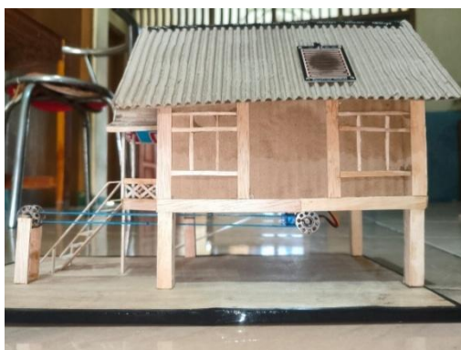
Gambar 14. Posisi sensor raindrops dan motor servo jemuran
