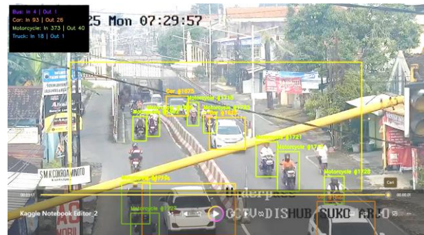
Gambar 8. Hasil Perhitungan video dengan Oversampling
